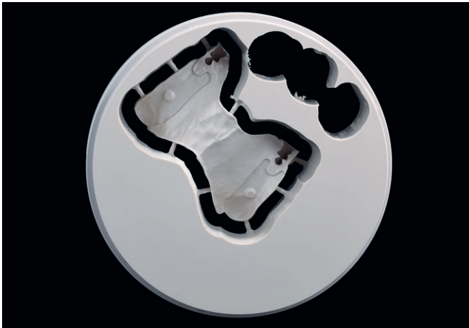
Fig. 29 L'armature de la prothèse partielle, usinée à partir d'un disque de polymère haute performance de la famille des PEEK.
